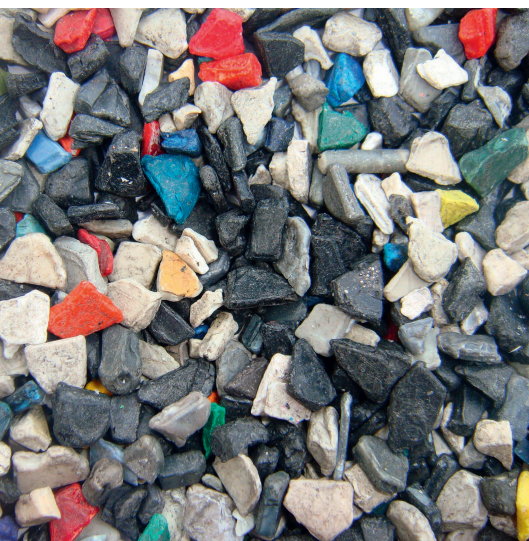
Saubere ABS-Fraktion: Die Separation erfolgt dabei unabhängig von der Farbe. © Harnos
