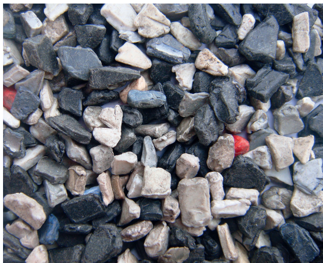
Saubere PS-Fraktion: Es können also auch komplett schwarz eingefärbte Materialgemische getrennt werden. © Harnos
